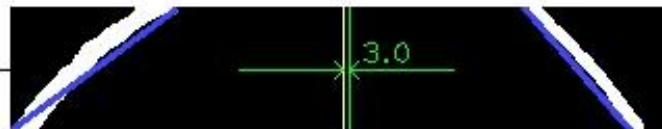
Rysowanie linii środkowej i odległości od znalezionych krawędzi
